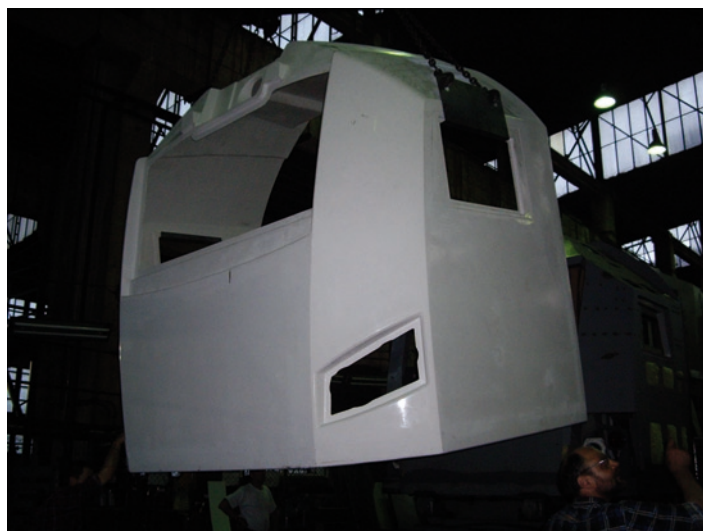
Fot. 4. Laminatowe poszycie kabiny maszynisty
